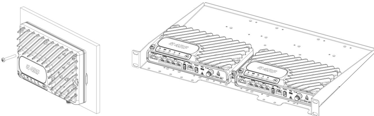
O Aprisa SRi tem um ponto de conexão para aterramento no canto superior esquerdo e no canto superior direito do chassi. Use os parafusos M4 fornecidos para aterrurar o chassi para um aterramento de proteção.
